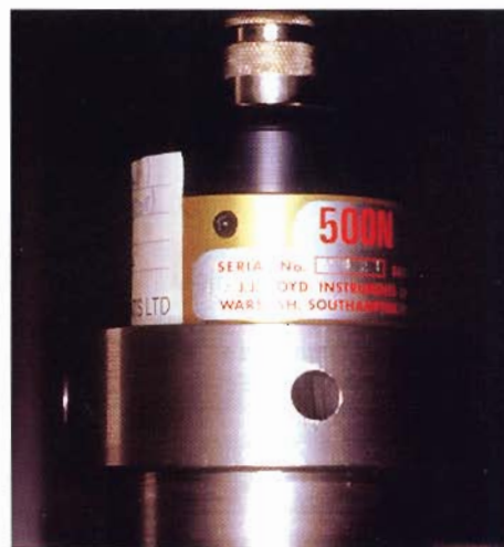
Fig. 5 - Cella di carico di 500 Newton adoperata per il test.
